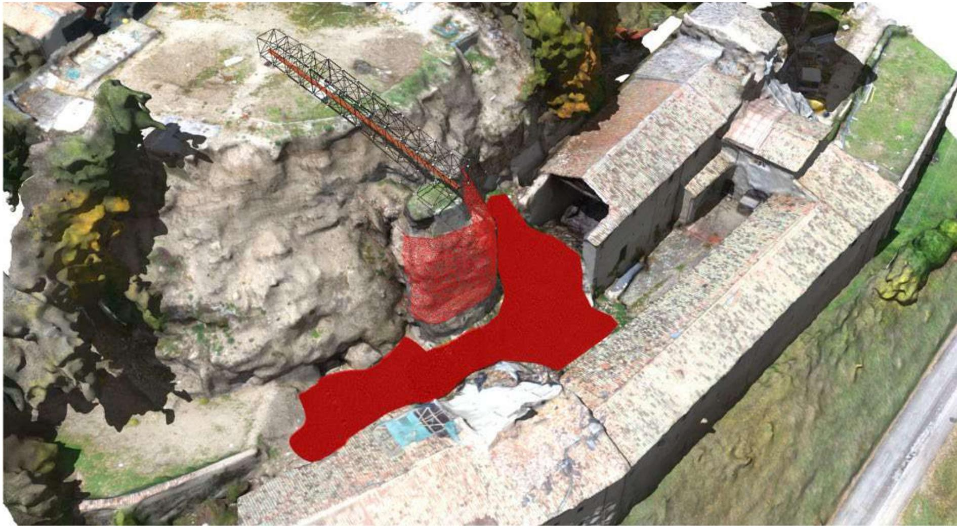
2\_ pannelli di contenimento e telo protettivo per raccolta materiale
